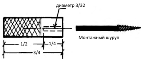
Рис. 10-22. Детали для изготовления зажима для планок.
