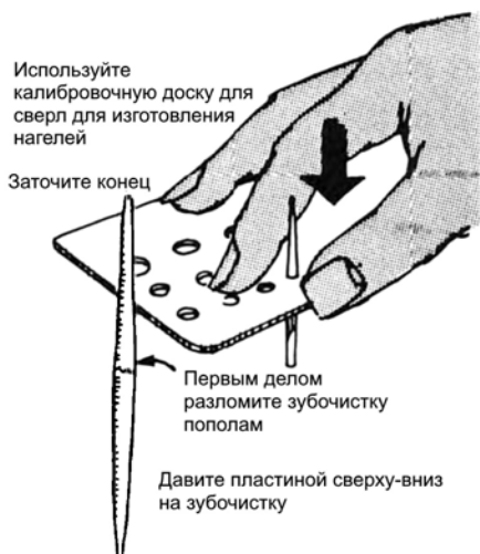
Рис. 19-2. Изготовление нагелей из зубочисток (Приводится с разрешения Northshore Deadeyes, Ltd.).
