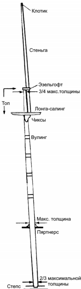
Рис. 12-4. Части мачты и марса (Приводится с разрешения Moonraker Publications).
