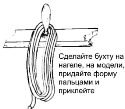
Рис. 19-15. Изготовление и установка бухты на нагели (Приводится с разрешения Moonraker Publications).
