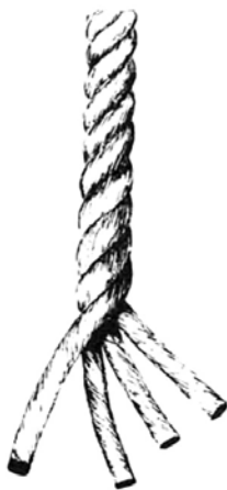
Четырепрядный трос тросовой работы, скрученный против часовой стрелки справа-налево
