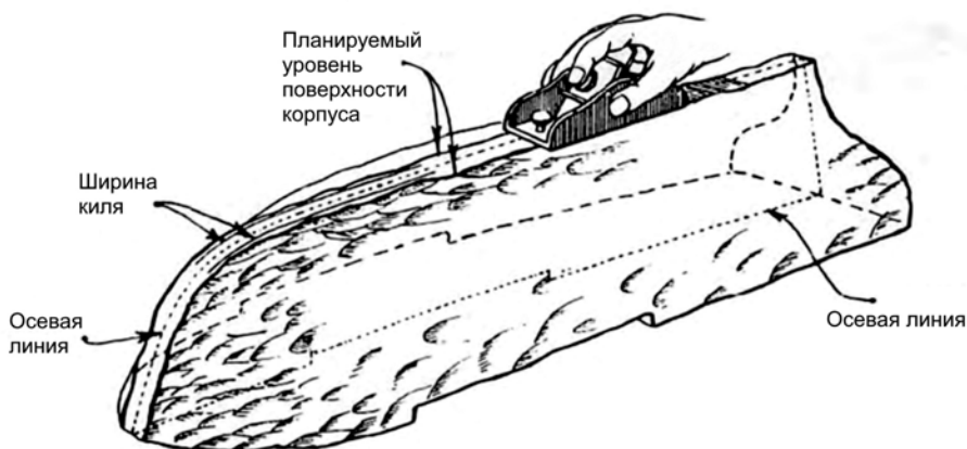
Рис. 10-4. Подготовка монолитного корпуса к установке киля (Приводится с разрешения Model Shipways).
