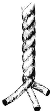
Трехпрядный трос тросовой работы, скрученный против часовой стрелки справа-налево
