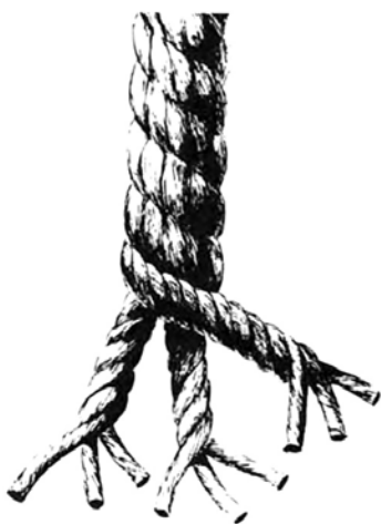
Девятипрядный трос кабельной работы, скрученный из трех трехпрядных тросов по часовой стрелке
