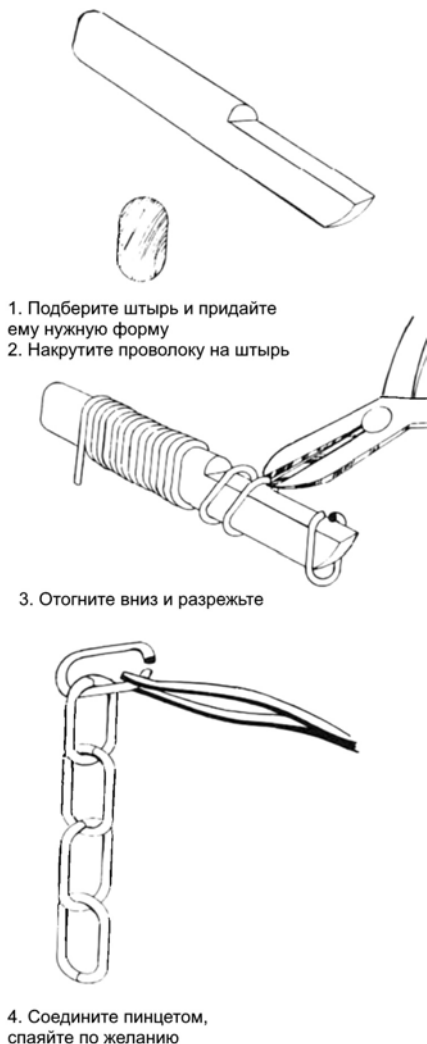
Рис. 19-17. Изготовление цепочек (Приводится с разрешения Ричарда Мансира).
