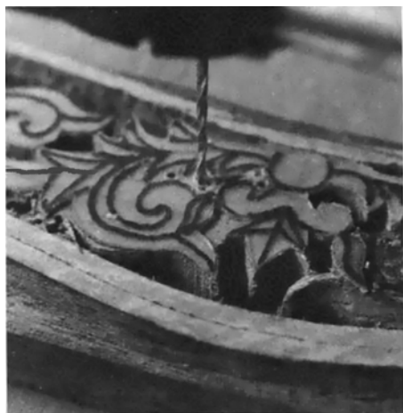
Рис. 10-29. Высверливание древесины при подготовке к резьбе (Приводится с разрешения Дэвида Стивенса).
