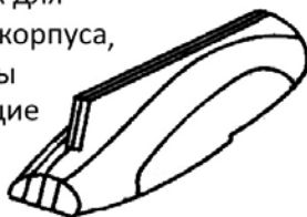
Рис. 10-6. Варианты послойных деревянных корпусов, изготавливаемых «методом бутерброда» (Приводится с разрешения Moonraker Publications).
