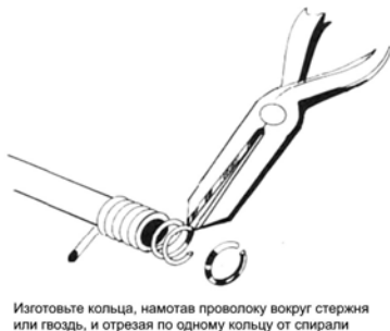
Рис. 19-18. Изготовление колец (Приводится с разрешения Ричарда Мансира).
